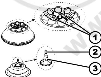
Fig. 15 : Montage et démontage du rotor
