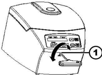
Fig. 16 : Déverrouillage d'urgence
